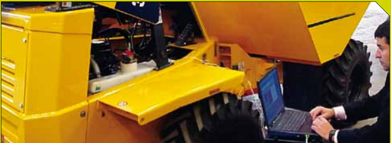
Mesure vibratoire FFT chez le client
