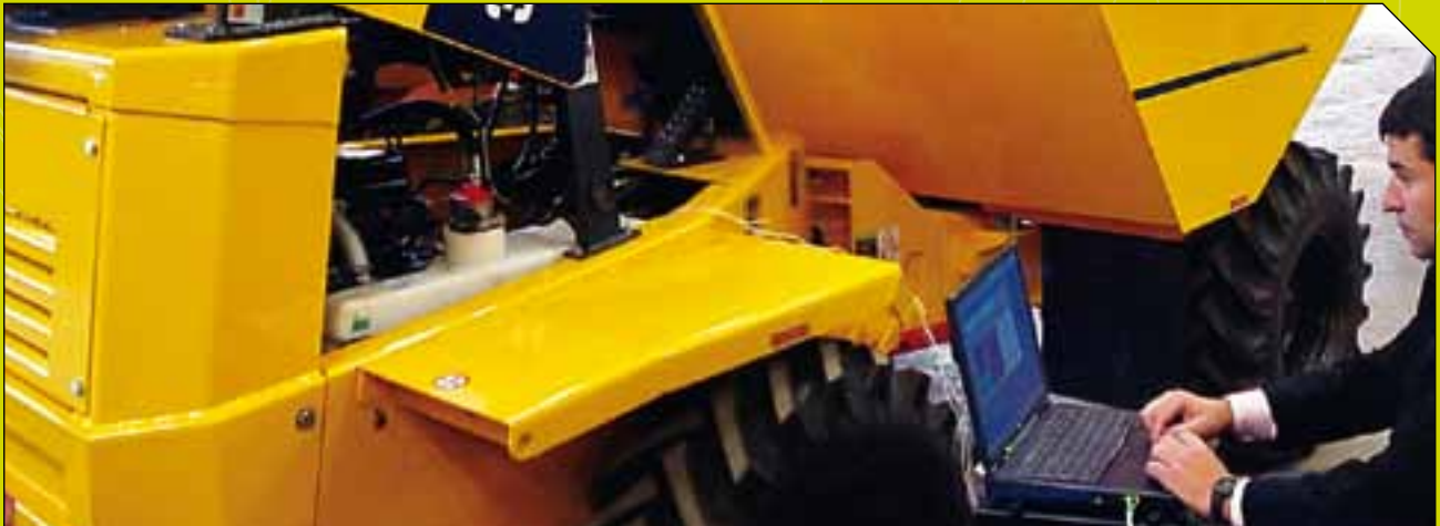
Medición de vibraciones
